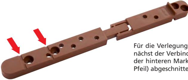
Für die Verlegung der ersten Dielenreihe wird zunächst der Verbinder je nach Dielenbreite an einer der hinteren Markierungen bzw. Einkerbungen (s. Pfeil) abgeschnitten.
