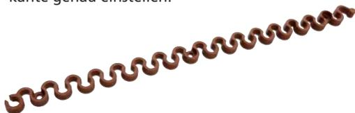
Die **Distanzleiste** ist für eine fachmännische Verlegung unerlässlich. Sie verhindert, dass sich Stauwasser zwischen Tragbalken und Dielenbrettern bilden kann und somit der gesamte Terrassenboden frühzeitig verrotten würde. Die Leisten sind je nach Bedarf zusammensteckbar oder beliebig kürzbar.
